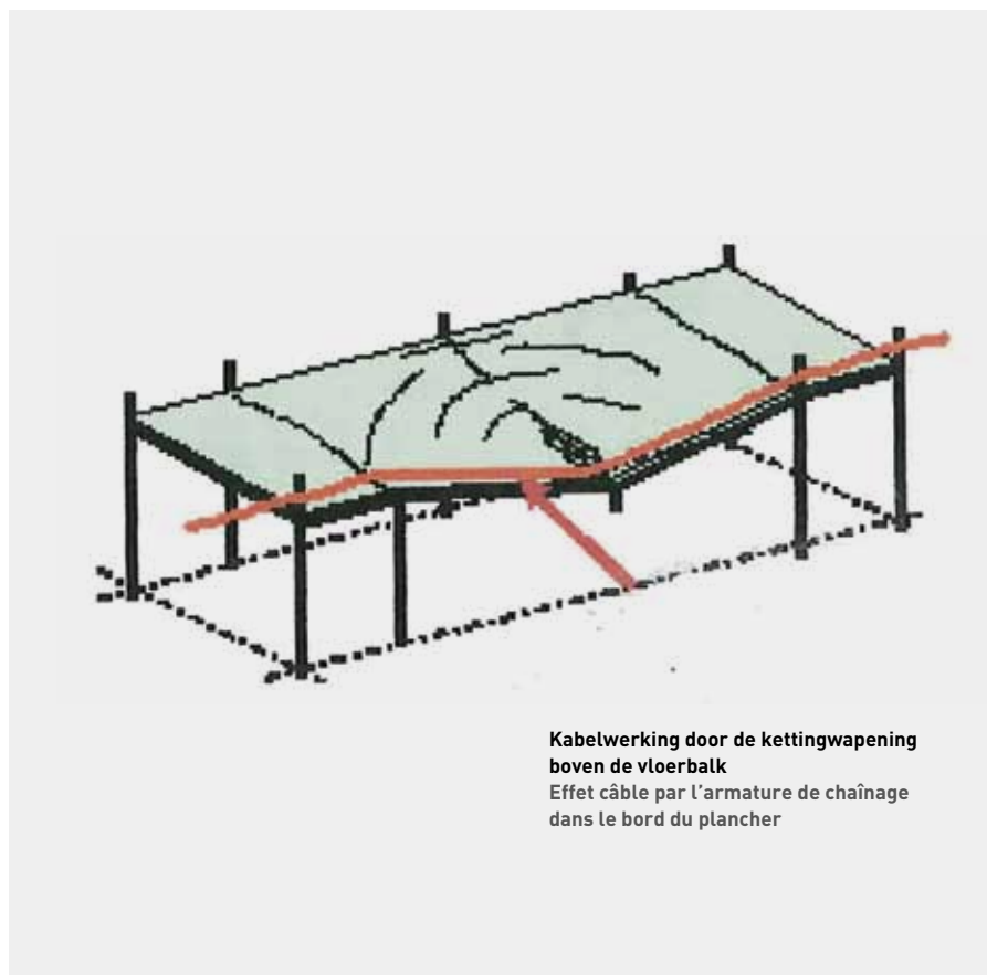
Fig.10: Illustratie van een mogelijk vervormingspatroon in een monoliete betonconstructie na het plotse wegvallen van een tussenkolom in de gevel ten gevolge van een accidentele actie.
