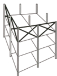
(d) staafwerkconstructie (d) Structure en treillis
