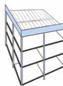
(c) Stijve randbalken (c) Poutres latérales rigides
