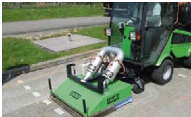
Figuur 9: Hete lucht (links) en selectieve heetwatertechniek (rechts) in actie op de proefparking Figure 9: Air chaud (à gauche) et technique d'eau chaude sélective (à droite) en action sur le parking expérimental
