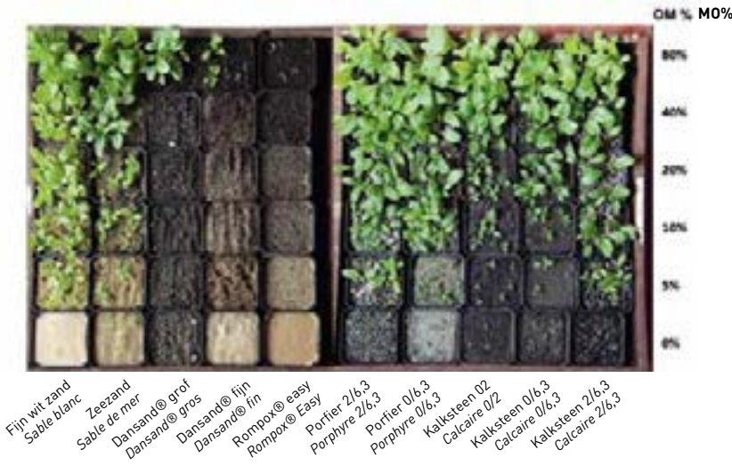
Figuur 3 – Proeven ter bepaling van de onkruidremmende werking van verschillende soorten voegvullingsmaterialen, met toenemende mate van vervuiling (OM = organisch materiaal)
