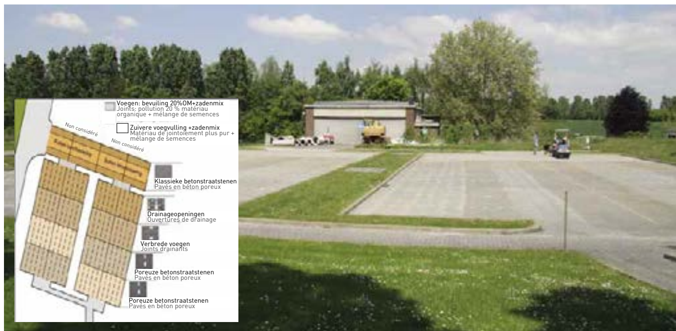
Figuur 7 - Proefparking van het OCW te Sterrebeek en toegepaste bestrijdingsscenario's Figure 7 - Parking expérimental du CRR à Sterrebeek et scénarios de lutte appliqués
