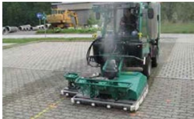
Figuur 9: Hete lucht (links) en selectieve heetwatertechniek (rechts) in actie op de proefparking Figure 9: Air chaud (à gauche) et technique d'eau chaude sélective (à droite) en action sur le parking expérimental
