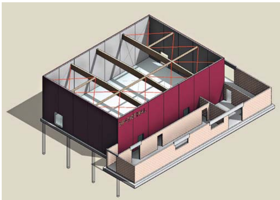
Fig. 1 - De sporthal is opgebouwd zonder kolommen die uitspringen in de gevels of in de binnenwanden.
