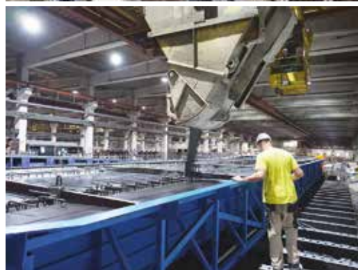
De productie van de brug – Het storten van het beton in de elementen.
